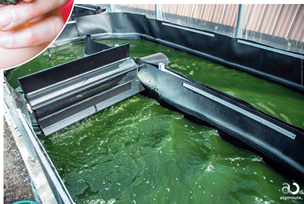
Bassins agités « Open pond system », pour la culture des micro-algues à grande échelle, développés par Alphabiotec
