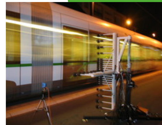
▲ Localisation et caractérisation des sources de bruits au passage d'un tramway par antenne microphonique.
