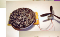
Cellule recouverte d'enrobé classique : le moteur s'arrête
